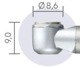
Cabezal: Ø 8,6 mm
