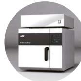
Contar con agua de alta calidad es esencial para mejorar la calidad de la esterilización. Dispositivo de suministro automático de agua con función de desalinización.
